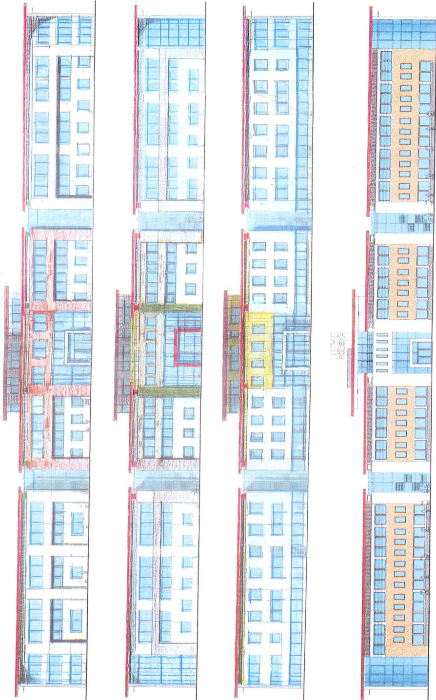
Rys. 6.29. Próby kolorystyczne i poszukiwanie akcentów kompozycji elewacji biurowca Heye Polska w Poznaniu (rys. R.A., animacja komputerowa – B. Siewczyński)
